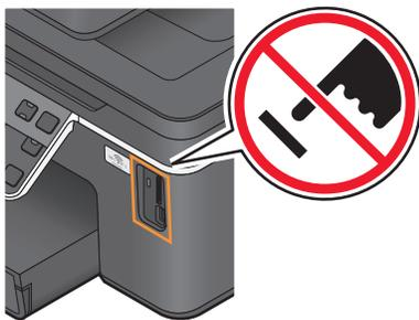
**Advertencia—Posibles daños:** No manipule ningún cable, adaptador de red, conector, dispositivo de memoria ni la impresora en las zonas que se muestran mientras esté imprimiendo, leyendo o escribiendo en la tarjeta de memoria. Se produce una pérdida de datos.
