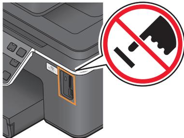
**Advertencia—Posibles daños:** No manipule ningún cable, adaptador de red, conector, dispositivo de memoria ni la impresora en las zonas que se muestran mientras esté imprimiendo, leyendo o escribiendo en el dispositivo de memoria. Se produce una pérdida de datos.
