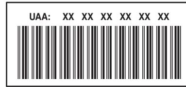
**Nota:** Se puede definir una lista de direcciones MAC en un punto de acceso (router) para que sólo los dispositivos cuyas direcciones MAC coincidan puedan operar en la red. A esto se le llama *filtrado MAC*. Si el filtrado MAC está activado en el punto de acceso y desea agregar una impresora a la red, deberá incluir la dirección MAC de la impresora en la lista de filtros MAC.
